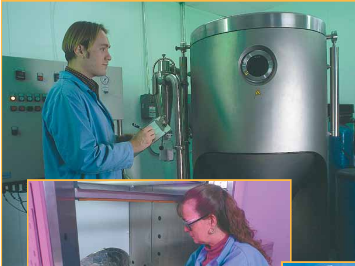
◀ 喷浆干燥机—这种独特工艺能达到陶瓷颗粒所需成分,而又可干燥陶瓷颗粒。
