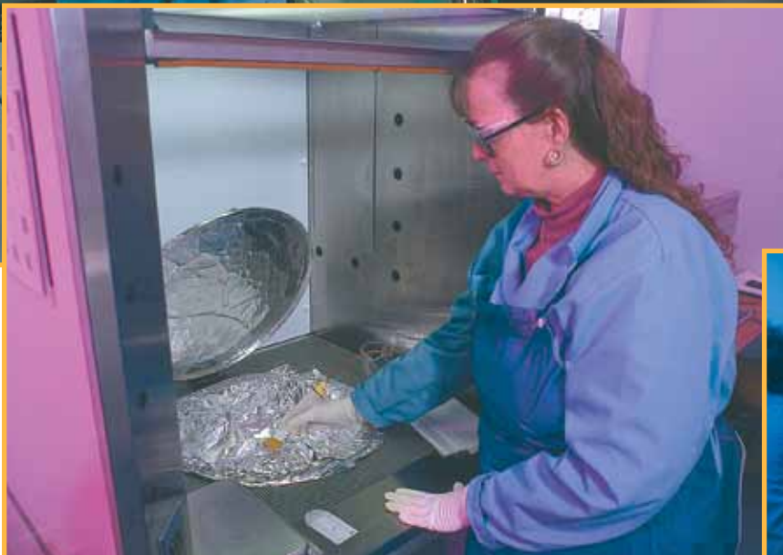
▲ 旋转涂膜—用高速旋转把正象光刻胶膜均匀涂在陶瓷基片上
